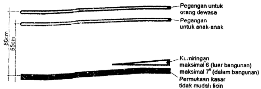
Gambar 5.11.1.d – Pegangan rambat pada ramp.
